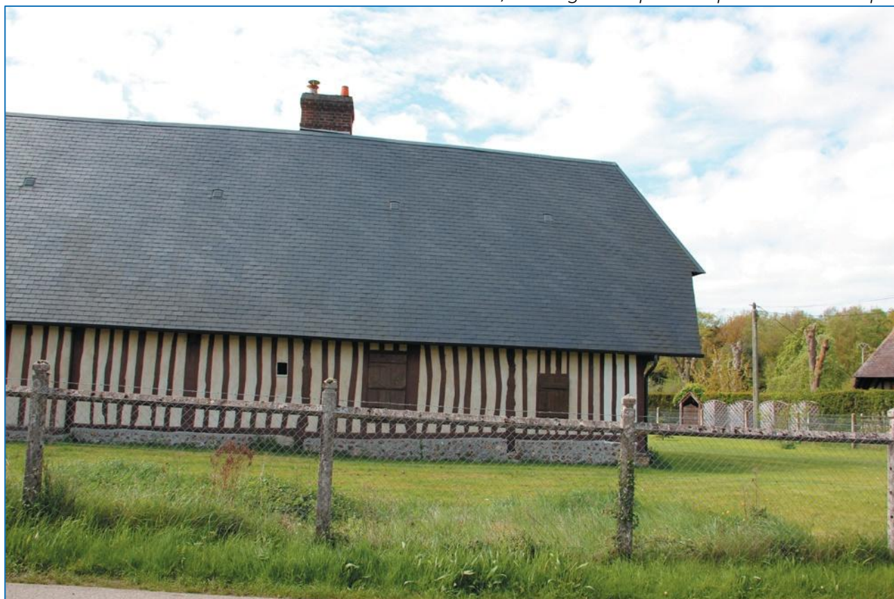
Ferme aux Champeaux - pan de bois et torchis enduit et chaulé
